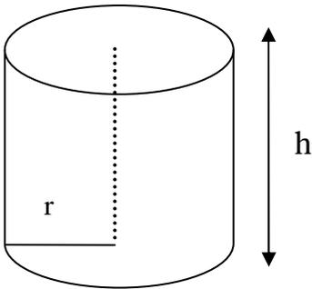
Volume d'un cylindre :  $V_{cyl} = A_{base} \times h = \pi \times r^2 \times h$
